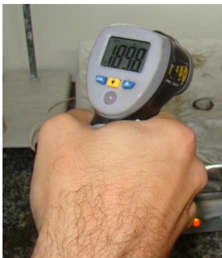
FIGURA 03. Avaliação da temperatura de aquecimento das amostras por termômetro InfraRed.
