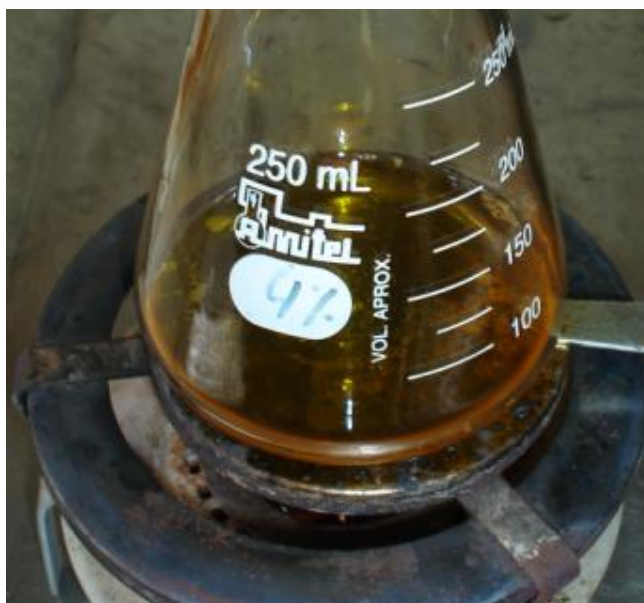
FIGURA 02. Tubo Erlenmayer com as frações de óleo de soja durante o processo de aquecimento.
